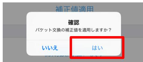
補正值適用時に右下のメッセージが表示された場合は、補正計算に必要なデータ取得が正しく行われなかったことによるエラーですので、もう一度最初からバケット交換キャリブレーションをやり直してください。
