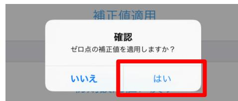
補正值適用時に右下のメッセージが表示された場合は、補正計算に必要なデータ取得が正しく行われなかったことによるエラーですので、もう一度最初からゼロ点キャリブレーションをやり直してください。
