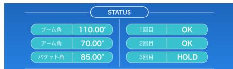
**7. ブーム上げ速度が、画面左インジケータの『100』を保持するように、バケットの高さが『3m』になるまでレバー操作を行いブームを上げ続けてください。(STEP 6)**
